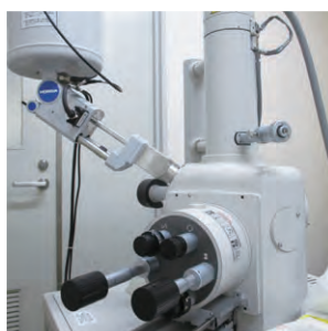
エネルギー分散型X線分析装置付走査型電子顕微鏡 S3000N Scanning electron microscope with energy dispersive x-ray spectroscopy S3000N
