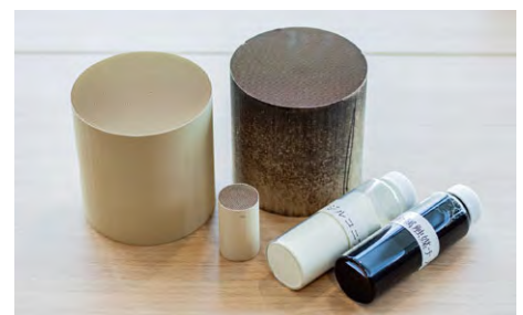
排ガス浄化用ハニカムセラミックスと貴金属とセリアナノ粒子触媒（研究室の開発品）
