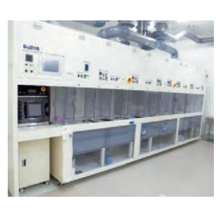
RCA洗浄装置 ダルトン 18-MR12 RCA cleaning system Dalton 18-MR 12
