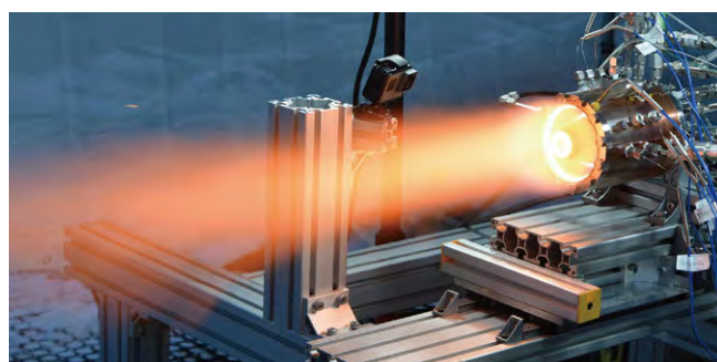
宇宙飛行実験用の回転デトネーションエンジン Rotating detonation engine for space flight experiment
