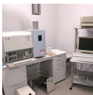
高周波誘導結合プラズマ発光分光分析装置 SPS7800 Inductively coupled plasma atomic emission spectrometer SPS7800
