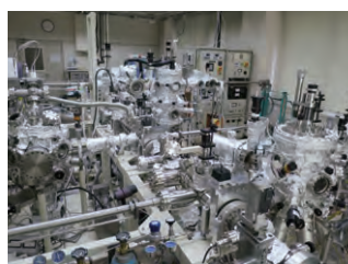
スパッタ/MBE/ ECRエッチング真空一貫システム Sputtering/MBE/ ECR etching system
