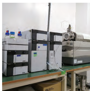
液体クロマトグラフ質量分析計 3200 QTRAP Liquid chromatograph-Mass spectrometry 3200 QTRAP
