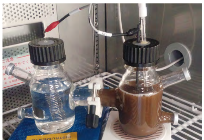
電気微生物培養系 2槽式培養系を用いて、電気を用いて微生物による汚染物の分解促進あるいは汚染水からの電気の取出し(発電)を行っている。
