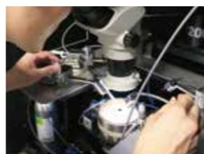
右:パワーデバイスの耐圧を測定する装置。電圧は1万ボルト、電流は500アンペアまで印加可能。
